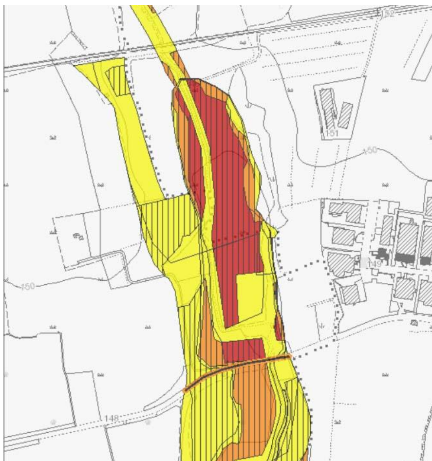
Fig. 3.14 - Particolare della Mappa del rischio nel Comune di Masate (da PGRA, 2020 - geoPortale regione Lombardia) lungo il rio Vallone. In rosso le aree a rischio elevato (R3) e in arancione le aree con rischio medio (R2), in giallo le aree con rischio moderato.
