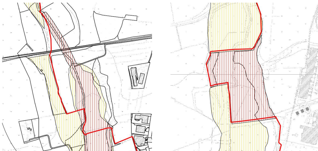
Fig.3.6 - Scenari di pericolosità del PGRA (Reticolo Secondario di Pianura) lungo il rio Vallone. A sinistra area a Nord, a destra area a Sud. In rosso lo scenario frequente, in arancione quello medio. Dati PGRA 2019. In rosso il confine comunale
