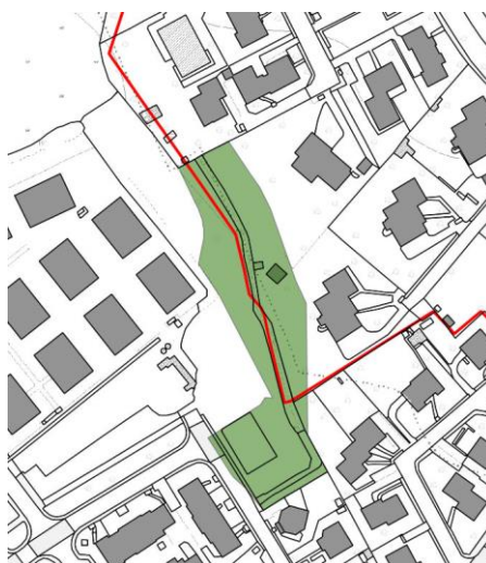
Fig. 4.7 - Areale a pericolosità alta per il Reticolo Secondario di Pianura proposto.
