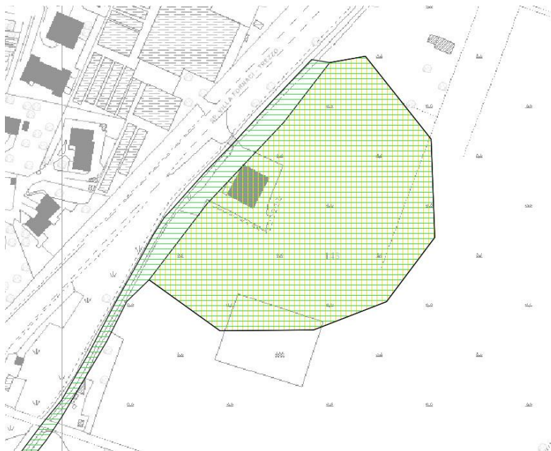
Fig. 3.11 - Sovrapposizione tra scenari di pericolosità lungo il torrente Trobbia (area centrale) del Reticolo Principale e Reticolo Secondario di Pianura. In rigato verticale è evidenziato lo scenario RSP, in rigato orizzontale lo scenario RP. Colori come nelle figg.3.4 e 3.6
