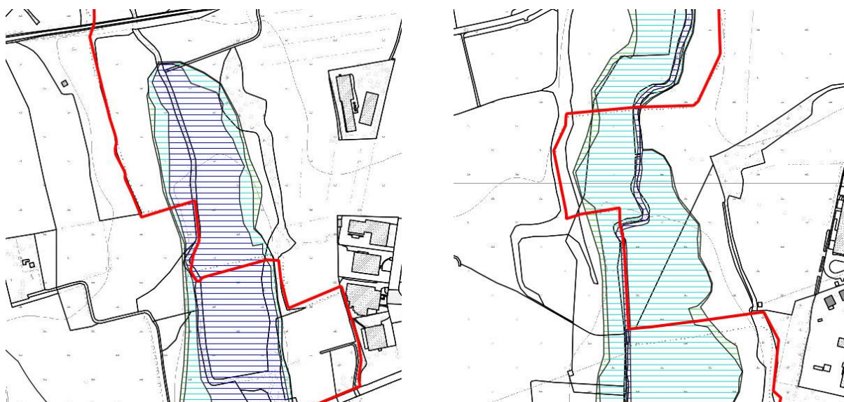
Fig. 3.4 - Scenari di pericolosità del PGRA (Reticolo Principale) lungo il rio Vallone nel Comune di Masate. In blu lo scenario con frequente, in azzurro lo scenario a poco frequente e in verde lo scenario raro. Dati PGRA 2020; . In rosso limite del comune.
