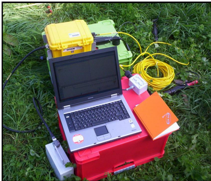
Fig. 2 – Strumentazione utilizzata per le prove MASW.
